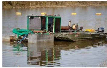
Saugt unter Wasser Staub, pardon Schlamm: Das Saugboot liest den Schlamm aus dem Barmer Hafenbecken aus. (Focke Strangmann)
