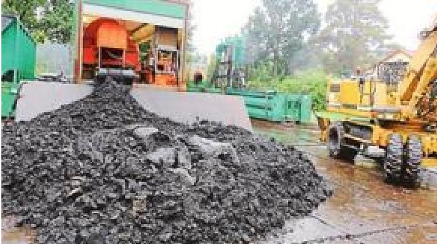
Wieder fest: Der sogenannte Schlammkuchen verlässt die Zentrifuge über ein Förderband und wird später mit Lastkraftwagen abgefahren.
